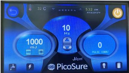
En función de la descripción del display. Regulamos los HZ (Velocidad de disparo) y por otro lado los MJ (Potencia del Láser). Y el siguiente paso es comenzar a utilizarlo.
